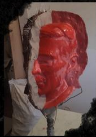
Прављење калуца од полиестера и стаклених влакана
